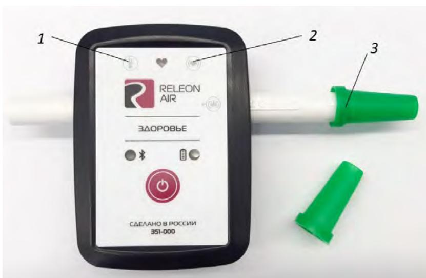
**Рис. 2.** Мультидатчик по физиологии: 1 — температура тела, 2 — пульс, 3 — частота дыхания (надет съёмный мундштук)
