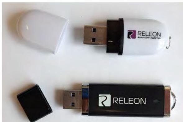
**Рис. 3.** Общий вид USB-флеш-накопителя (внизу) и Bluetooth-адаптера (вверху)
